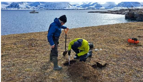
Bestimmung der Auftautiefe des Permafrosts
