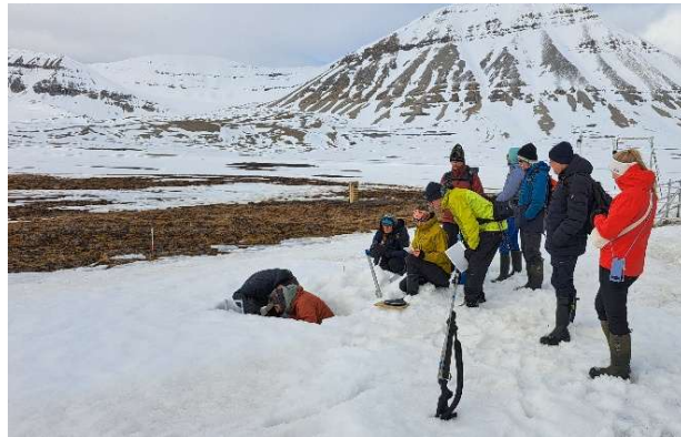
Schneeschant zur Dichte- und Massenbestimmung
